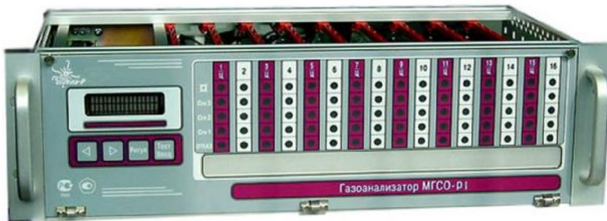
Рисунок 4 – Внешний вид «Терминала-А» газоанализаторов стационарных оптических МГСО-Р1
